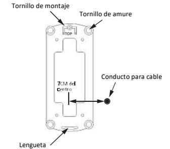
5. Si la conexión del cable es realizada bajo agua, la unión debe ser **estanca** (use una unión estanca, prensacable o unión con resina) . De lo contrario el agua llegará a la lámpara a través del cable.
